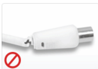
Kabler med synlige skader
