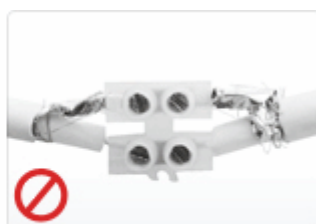
Kabler med forkerte eller dårlige samlinger
